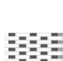
Ter illustratie: Vlaams verband met een halve steen gebruikt als kop
