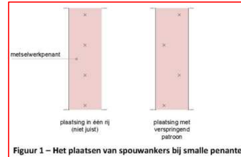
Figuur 1 – Het plaatsen van spouwankers bij smalle penanten
