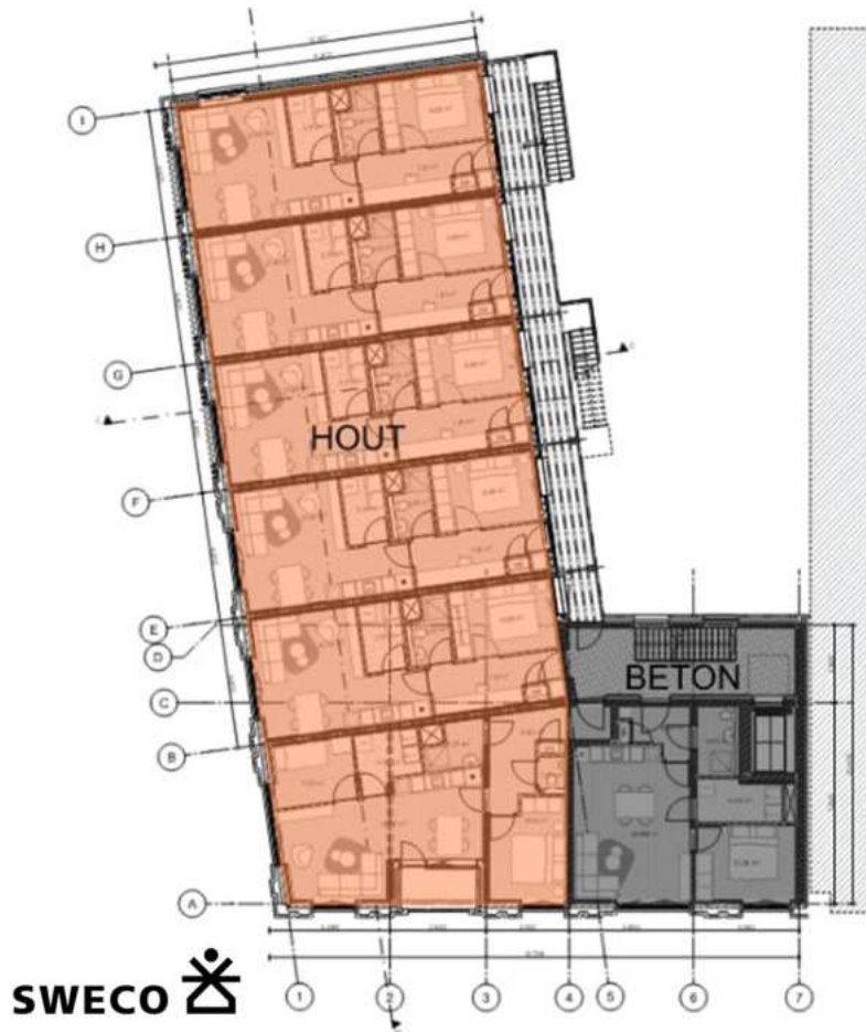
Figuur 2. Overzicht hout- en betonconstructie.
