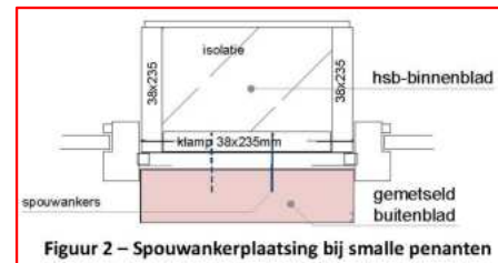
Figuur 2 – Spouwankerplaatsing bij smalle penanten
