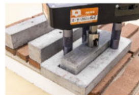
Figuur 2: Beproeving van de hechtsterkte
