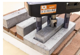
Figuur 2: Beproeving van de hechtsterkte
